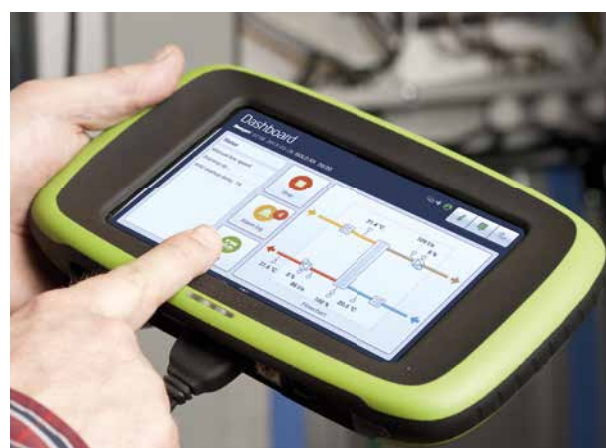
Programowanie lub kontrolowanie pracy centrali odbywa się za pomocą programatora z prostym, intuicyjnym menu.
