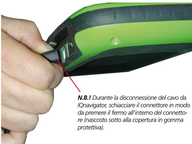
**N.B.!** Durante la disconnessione del cavo da IQnavigator, schiacciare il connettore in modo da premere il fermo all'interno del connettore (nascosto sotto alla copertura in gomma protettiva).
