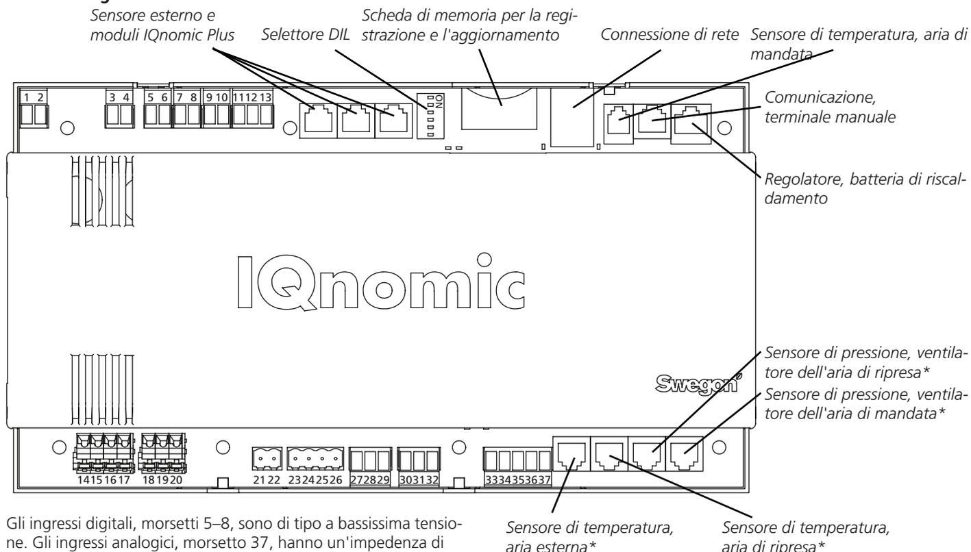
Gli ingressi digitali, morsetti 5–8, sono di tipo a bassissima tensione. Gli ingressi analogici, morsetto 37, hanno un'impedenza di ingresso di 66 k.Ω.
