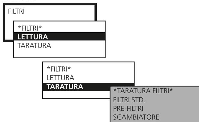
sia l'aria in mandata che quella in ripresa mentre se si sostituisce solo un filtro è sufficiente tarare la direzione dell'aria corrispondente.
