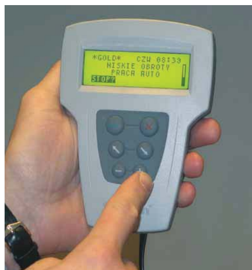
Programowanie lub kontrolowanie pracy centrali odbywa się za pomocą programatora z prostym, intuicyjnym menu.
