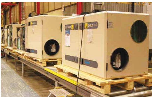
Stanowiska montażowe central GOLD jednej z kilku linii produkcyjnych zakładów w Kvänum.
