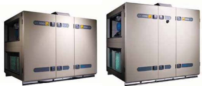
Centrale GOLD RX z wymiennikiem rotacyjnym - wielkości 14-40 (w centrali o wielkości 40 wyłącznik serwisowy jest na środkowych drzwiach inspekcyjnych).
