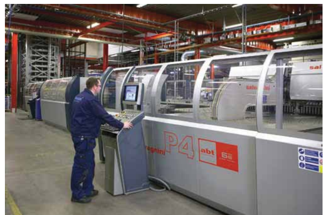
Jedna z trzech kompletnie zautomatyzowanych linii produkujących panele do obudów central.
