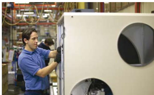
Nowoczesna linia produkcyjna central klimatyzacyjnych GOLD
