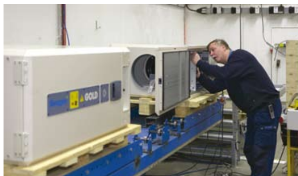
Stanowiska kontrolno-pomiarowe central klimatyzacyjnych GOLD SD
