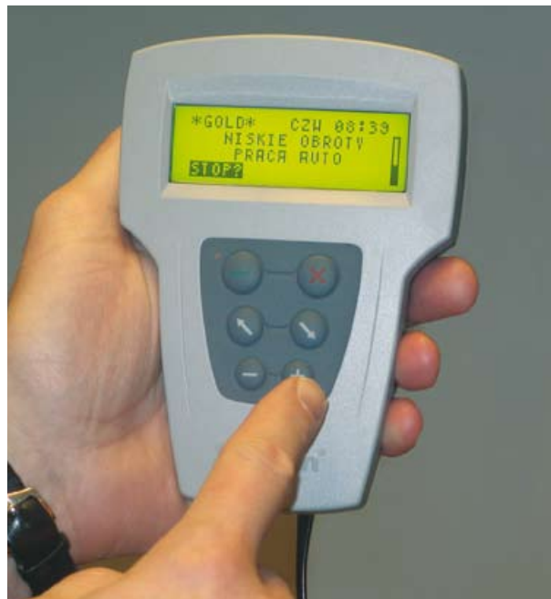
Do regulacji i kontroli pracy służy specjalnie skonstruowany do tego celu programator
