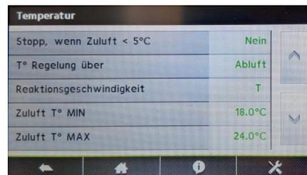
Die niedrigste Zulufttemperatur im Kühlbetrieb und die höchste Zulufttemperatur im Heizbetrieb sollten hier eingestellt werden (gewünscht und auch erreichbar). Zuluft T° MIN mit 19°C und Zuluft T° MAX mit 23°C werden in den meisten Fällen als angenehm empfunden.
