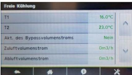
Hier können als T1 (Außenlufttemperatur) und T2 (Ablufttemperatur) Bedingungen für die Freigabe der reduzierten Wärmerückgewinnung eingestellt werden. Mit Überschreiten dieser Werte ist eine Freie Kühlung möglich. Weitere Informationen hierzu finden Sie in der Betriebs- und Wartungsanleitung.
