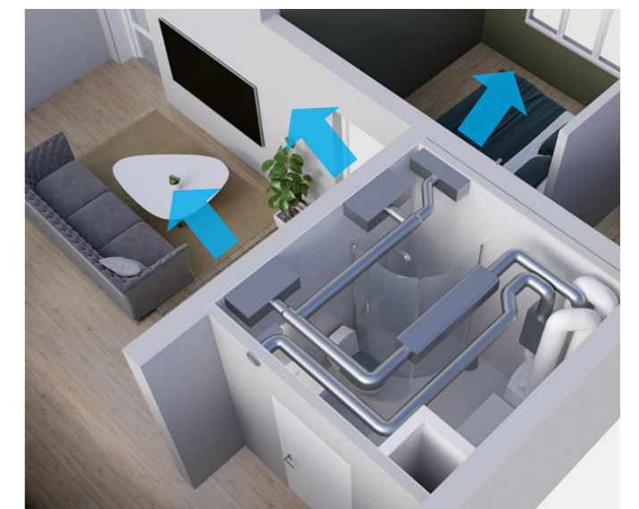
CASA Climate CCF asennettuna kylpyhuoneen alakaton yläpuolelle niin, että säleiköt on asennettu olohuoneen seinään ja makuuhuoneen seinään
