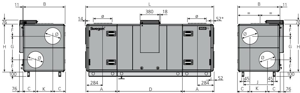
\* L'unità di trattamento aria viene fornita senza pannello di connessione terminale se verrà collegato un accessorio per canali collocato in un alloggiamento isolato. L'AHU può anche essere dotata di pannello di collegamento terminale full face (accessorio).
