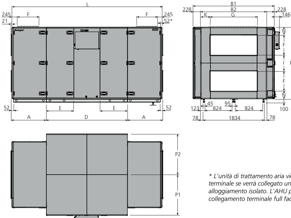
\* L'unità di trattamento aria viene fornita senza pannello di connessione terminale se verrà collegato un accessorio per canali collocato in un alloggiamento isolato. L'AHU può anche essere dotata di pannello di collegamento terminale full face (accessorio).
