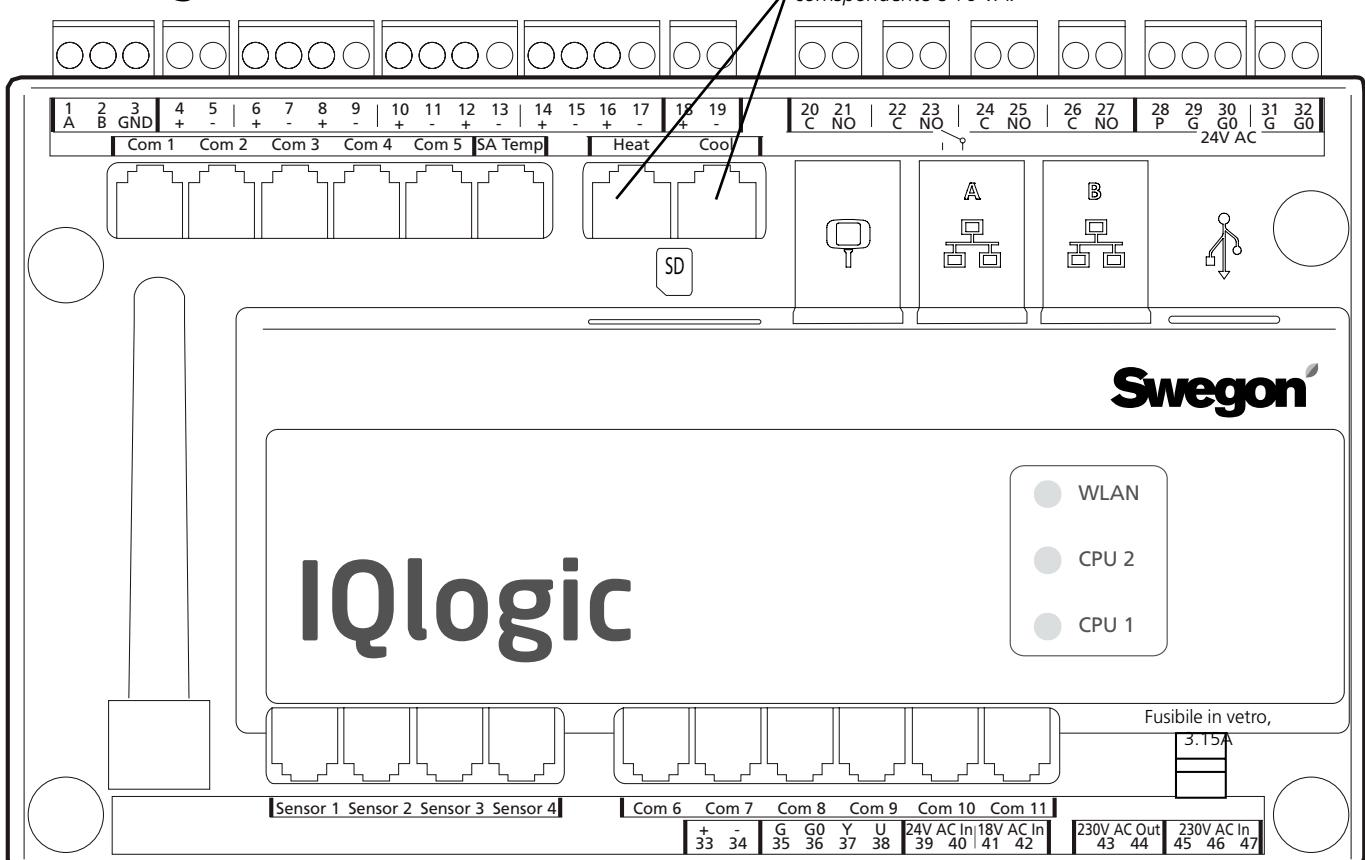
Gli ingressi digitali, morsetti 4-17, sono di tipo a bassissima tensione. Gli ingressi analogici, morsetti 18-19, hanno un'impedenza di ingresso di 66 kΩ. Tensione di controllo di 230 V CA sui morsetti esterni 101 (L) e 102 (N).
