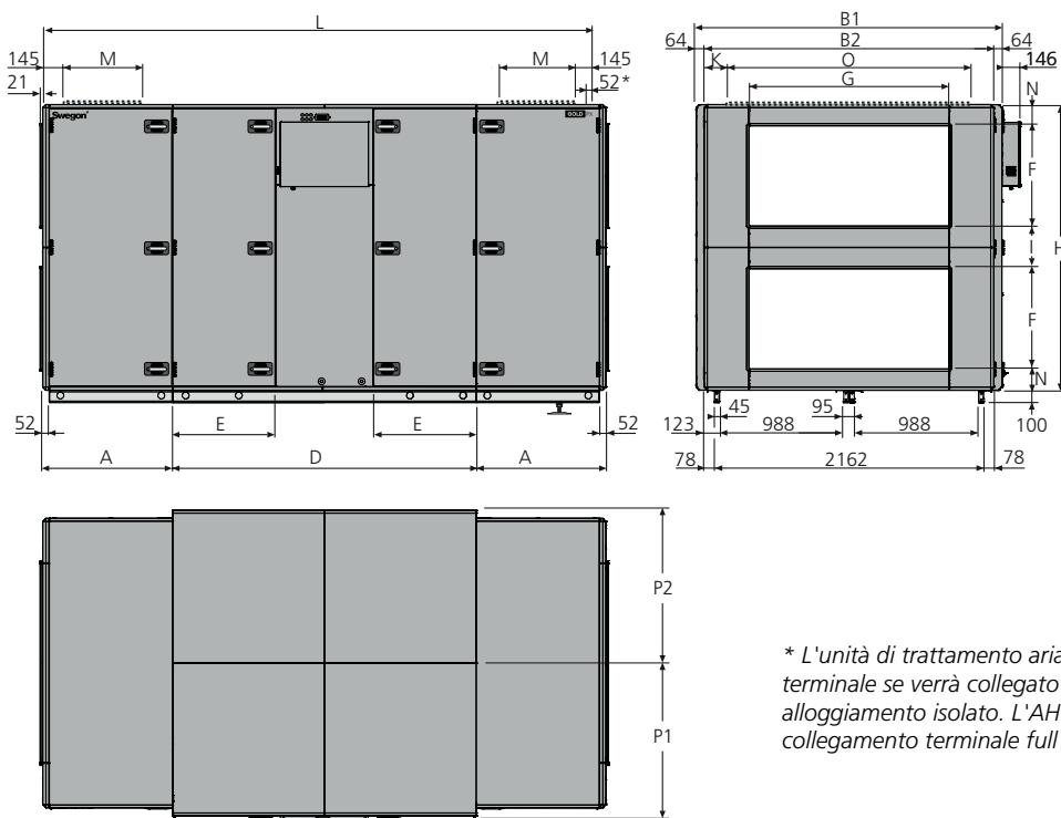
\* L'unità di trattamento aria viene fornita senza pannello di connessione terminale se verrà collegato un accessorio per canali collocato in un alloggiamento isolato. L'AHU può anche essere dotata di pannello di collegamento terminale full face (accessorio).
