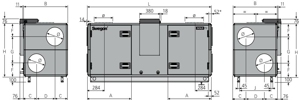
\* L'unità di trattamento aria viene fornita senza pannello di connessione terminale se verrà collegato un accessorio per canali collocato in un alloggiamento isolato. L'AHU può anche essere dotata di pannello di collegamento terminale full face (accessorio).
