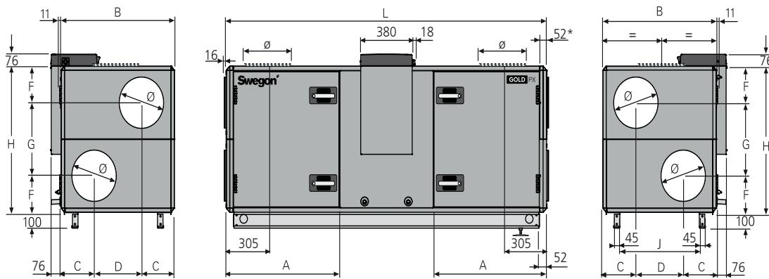
\* L'unità di trattamento aria viene fornita senza pannello di connessione terminale se verrà collegato un accessorio per canali collocato in un alloggiamento isolato. L'AHU può anche essere dotata di pannello di collegamento terminale full face (accessorio).
