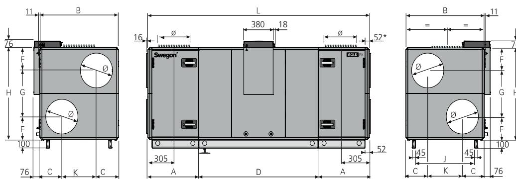
\* L'unità di trattamento aria viene fornita senza pannello di connessione terminale se verrà collegato un accessorio per canali collocato in un alloggiamento isolato. L'AHU può anche essere dotata di pannello di collegamento terminale full face (accessorio).
