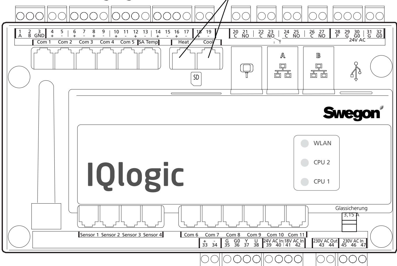
Digitale Eingänge, Anschlussklemme 4-17, Kleinspannungstyp.
