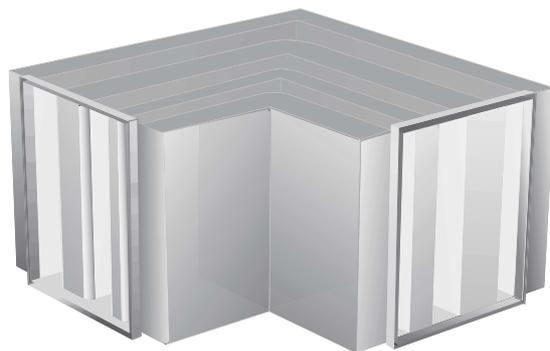
**Figure 5.** Le coude LARGO offre une répartition égale de la vitesse en aval grâce à l'utilisation des écrans acoustiques comme déflecteurs.
