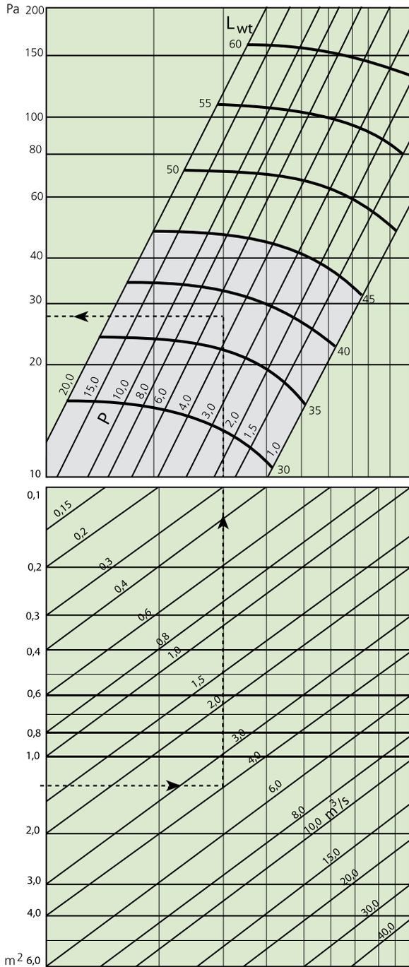
Diagramm 1. Korrektur für anderen Anschluss
