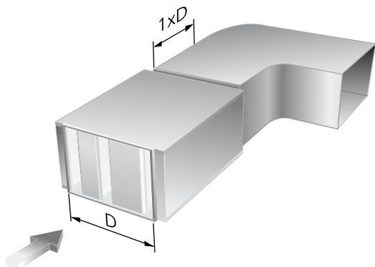
Abbildung 5. Schalldämpfer vor oder nach einem Bogen
