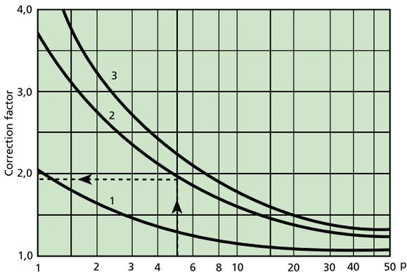
Kurve 1; Kammer-Kanal, Kurve 2; Kanal-Kammer, Kurve 3; Kammer-Kammer
