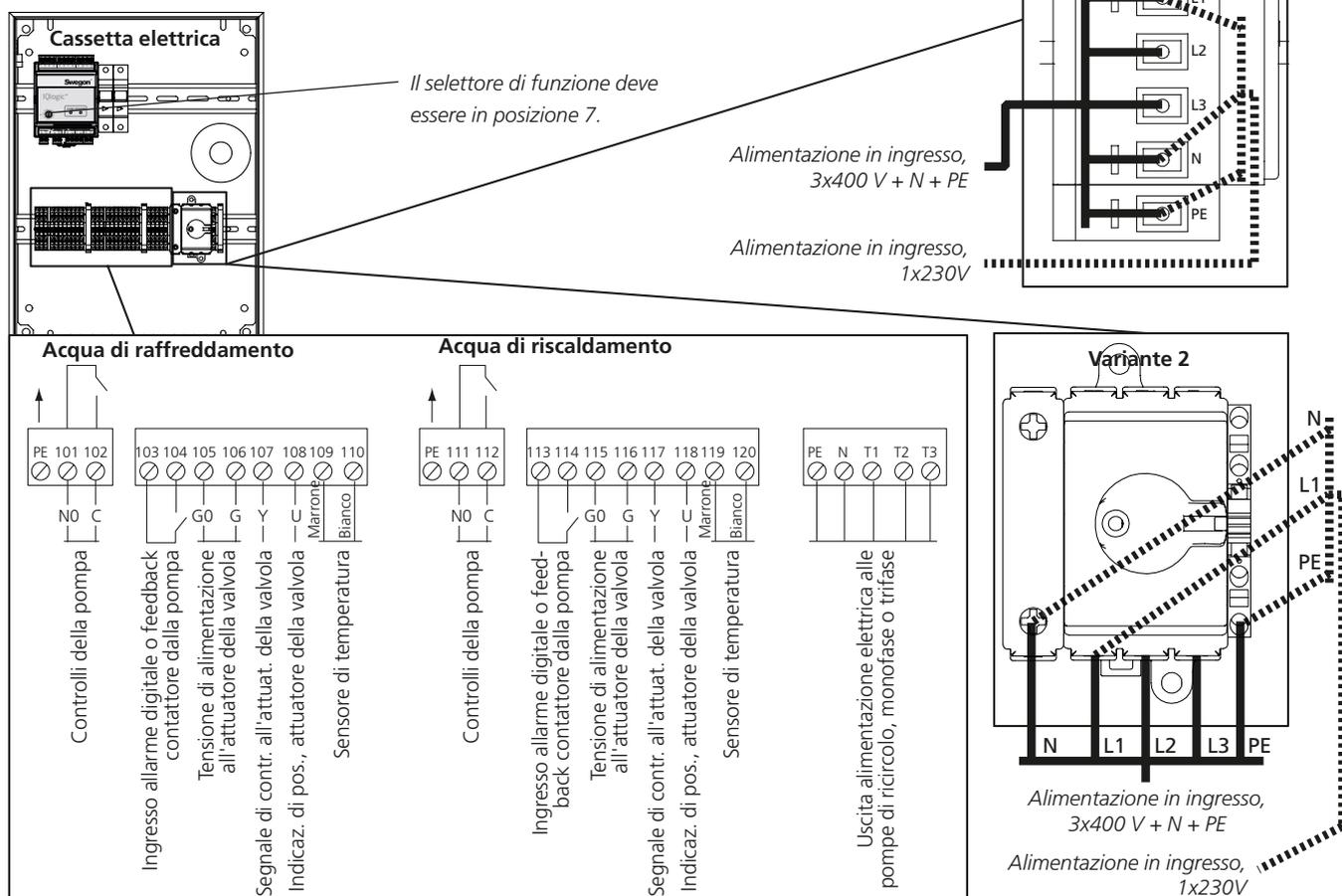
Il cablaggio deve essere realizzato da un elettricista qualificato in conformità con le disposizioni locali sulla sicurezza elettrica. Il selettore di funzione deve essere impostato sulla posizione 7; vedere la figura sopra.
