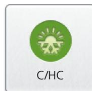
Mit der Funktion C/HC wird eine Kältemaschine (RX/C) oder eine reversible Wärmepumpe/Kältemaschine (RX/HC) im Gerät GOLD RX/C bzw. GOLD RX/HC gesteuert.
