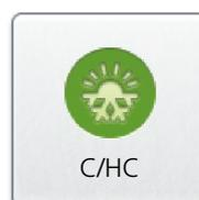
La fonction C/HC commande le module de refroidissement (RX/C) ou le module réversible pompe à chaleur/refroidisseur de la centrale GOLD RX/C ou GOLD RX/HC.
