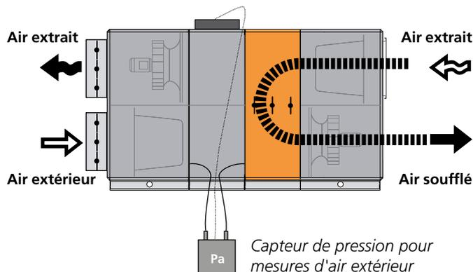
Débit d'air extérieur maintenu constant par capteur de pression
