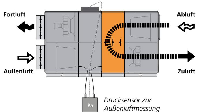
Der Außenluftvolumenstrom wird mit Drucksensoren konstant gehalten.
