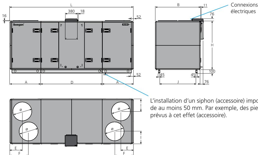
L'installation d'un siphon (accessoire) impose de surélever la centrale de au moins 50 mm. Par exemple, des pieds de support peuvent être prévus à cet effet (accessoire).
