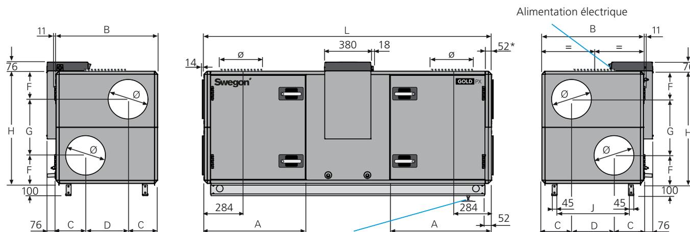
L'installation d'un siphon (accessoire) impose de surélever la centrale GOLD d'au moins 50 mm, Par exemple, des pieds de support peuvent être prévus à cet effet (accessoire).
