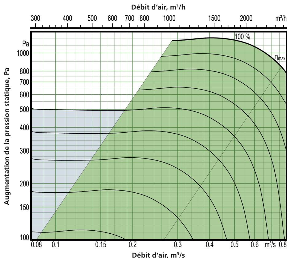
Puissance arbre moteur : 1,15 kW (variante de puissance 2)
