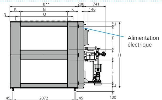
L'installation d'un siphon (accessoire) impose de surélever la centrale GOLD d'au moins 50 mm.
