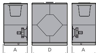
La centrale peut être divisée en trois modules sur le site d'installation.
