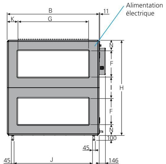
\* La CTA est fournie sans panneau d'extrémité lorsqu'il est prévu un accessoire de gaine logé dans un caisson isolé. La CTA peut également être fournie avec panneau de raccordement à passage d'air intégral (en option).
