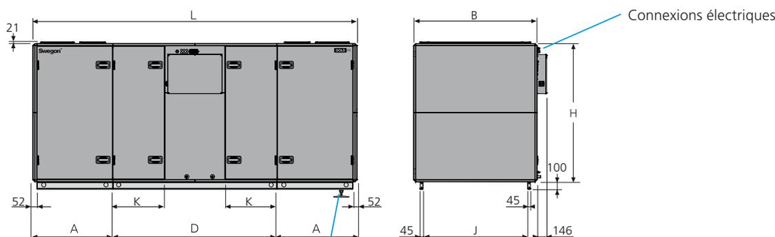
L'installation d'un siphon (accessoire) impose de surélever la centrale de au moins 50 mm. Par exemple, des pieds de support peuvent être prévus à cet effet (accessoire).
