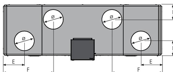
L'installation d'un siphon (accessoire) impose de surélever la centrale de au moins 50 mm. Par exemple, des pieds de support peuvent être prévus à cet effet (accessoire).
