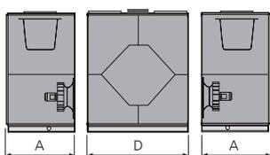
La centrale peut être divisée en trois modules sur le site d'installation.
