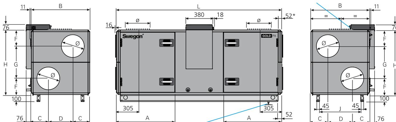
L'installation d'un siphon (accessoire) impose de surélever la centrale GOLD d'au moins 50 mm, Par exemple, des pieds de support peuvent être prévus à cet effet (accessoire).
