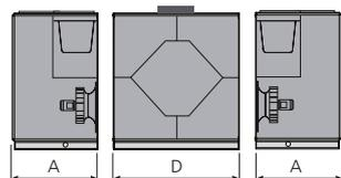
La centrale peut être divisée en trois modules sur le site d'installation.
