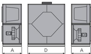
La centrale peut être divisée en trois modules sur le site d'instal- lation.
