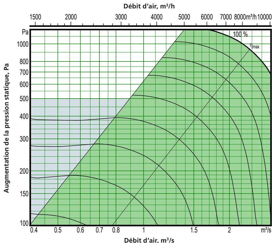
Puissance arbre moteur : 3,4 kW (variante de puissance 2)
