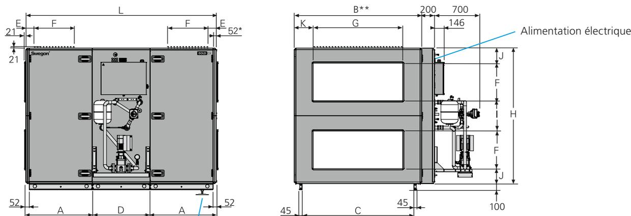
L'installation d'un siphon (accessoire) impose de surélever la centrale GOLD d'au moins 50 mm. Par exemple, des pieds de support peuvent être prévus à cet effet (accessoire). S'applique à la version côté droit avec le ventilateur de soufflage en haut à droite et à la version côté gauche avec le ventilateur de soufflage en haut à gauche.
