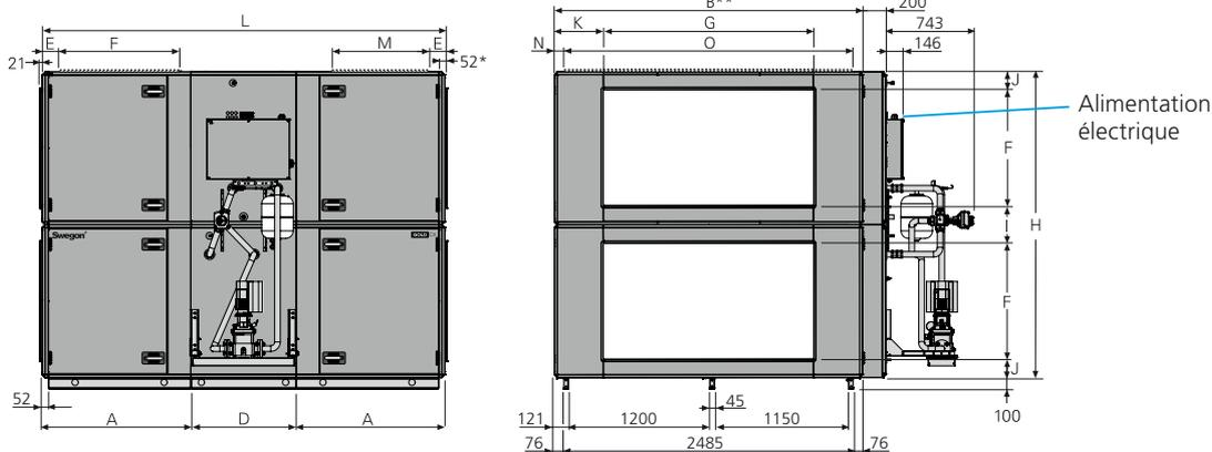
L'installation d'un siphon (accessoire) impose de surélever la centrale GOLD d'au moins 50 mm.
