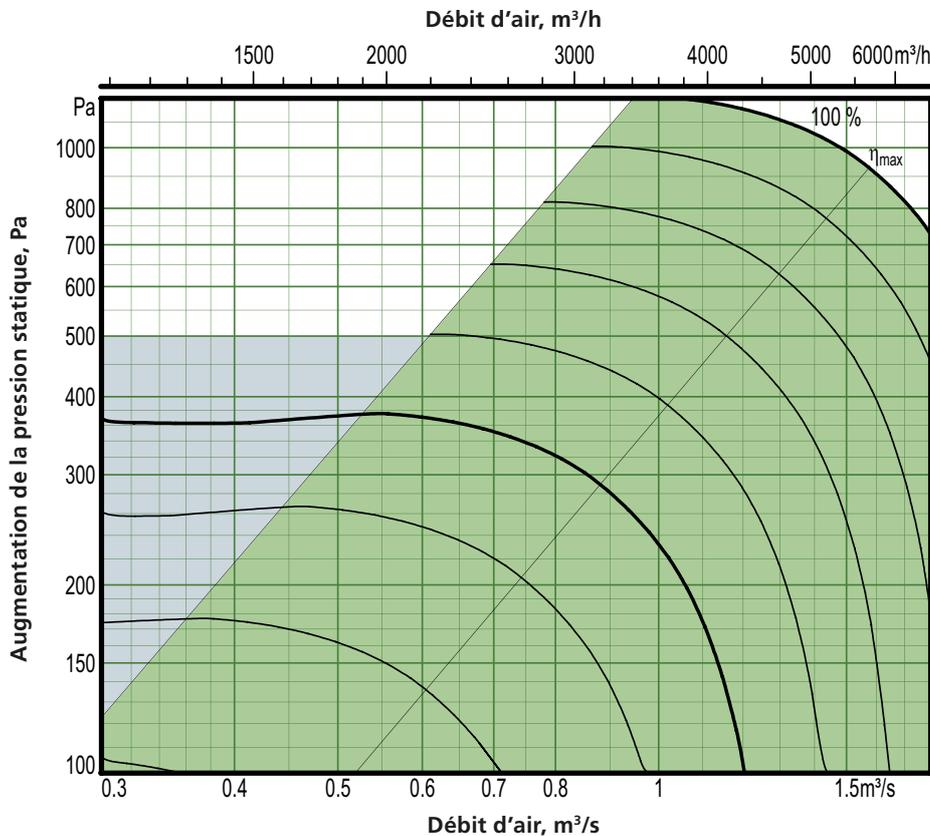
Puissance arbre moteur : 2,4 kW (variante de puissance 2)
