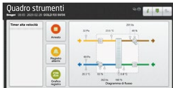
Esempio di diagramma di flusso per il Web Server integrato.
