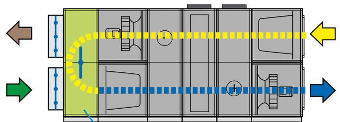
Section de recyclage d'air section RX/HC (accessoire)
