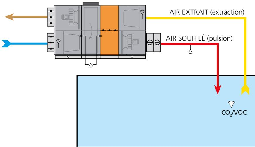
La fonction ReCO<sub>2</sub> vise à garantir la qualité/température de l'air voulue en recyclant l'air extrait et en limitant l'arrivée d'air extérieur.
