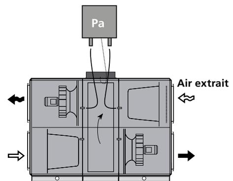
Principe de connexion du dégivrage avec capteur de pression distinct.
