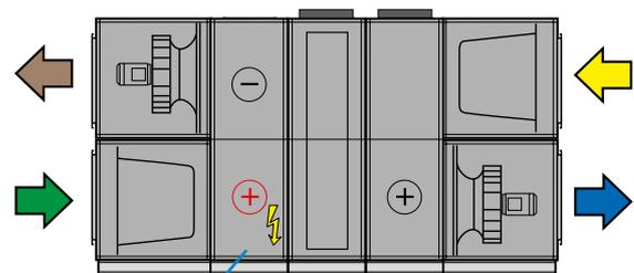
La batterie de chauffage électrique est installée dans le RX/HC (accessoire)
